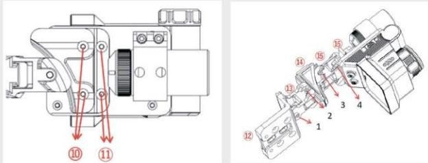
1. Полностью натяните лук и посмотрите на термографию через глазок. С помощью шестигранного ключа на 1/8 дюйма отрегулируйте горизонтальные и вертикальные направляющие так, чтобы глазок был совмещен с рамкой глазка, а основание лука - с центром термографического дисплея;
